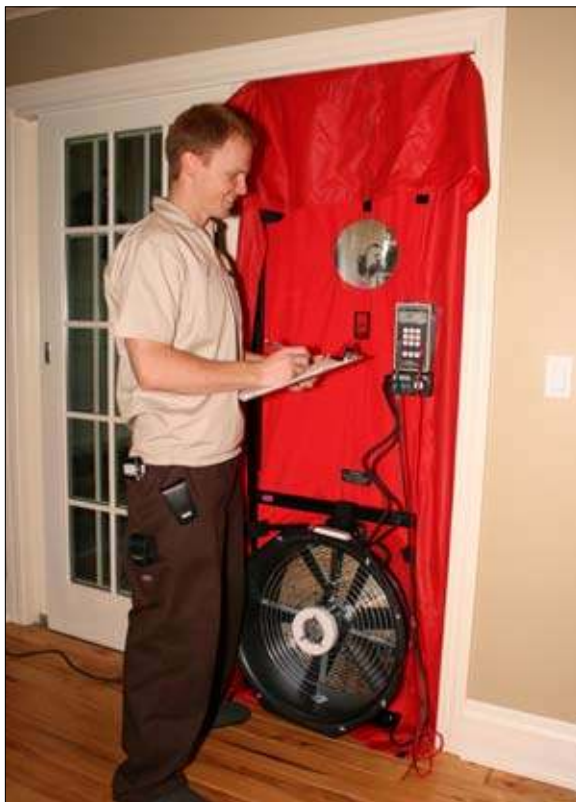
EA51 Blower Door Test Setup
